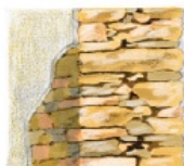
mur ancien souvent maçonné à la terre, construit pour le climat (intérieur et extérieur)
